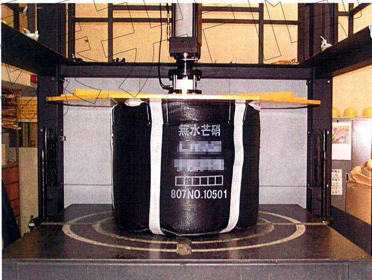
写真2 圧縮試験及び積重ね試験状況
