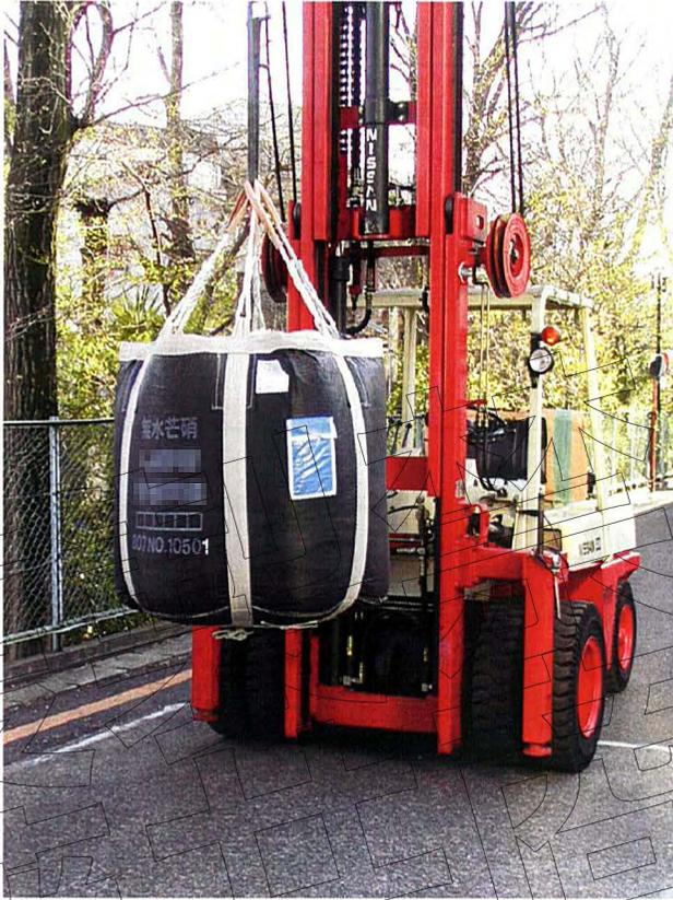
写真 3 落下衝撃試験状況
